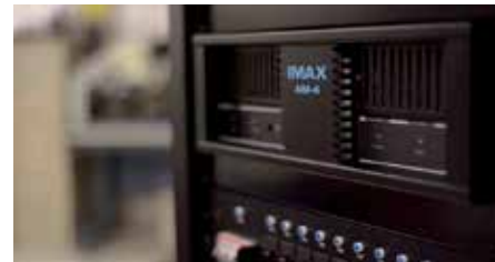
Power Amplifier ที่ IMAX ใช้จะมีกำลังขับตั้งแต่ 12000-20000 วัตต์
