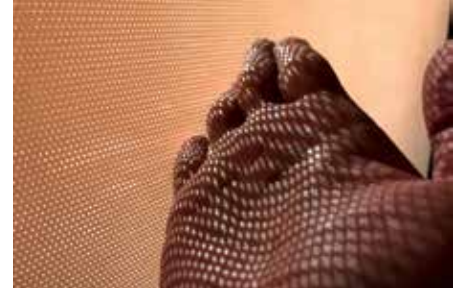
จอรูที่เสียงผ่านได้ (Acoustic Transparent Screen, AT) แสงส่วนหนึ่งจะผ่านไปยังด้านหลัง ทำให้ความสว่างของภาพลดลงไป
