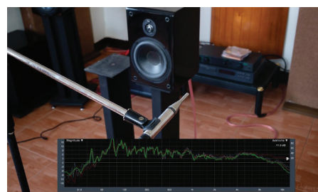
เมื่อเลื่อนไมค์ออกไปด้านข้าง บริเวณ Crossover Point ก็จะไม่พบ Dip มีแต่ระดับ Magnitude ที่ลดลง เนื่องจากระยะห่างของทาง Off Axis
