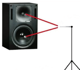
เมื่อไมค์ออกไปอยู่ด้านข้างก็ไม่พบ Dip ตรง Crossover Point เนื่องจากระยะห่างของไมค์กับ Woofer และ Tweeter ยังเท่ากันอยู่
