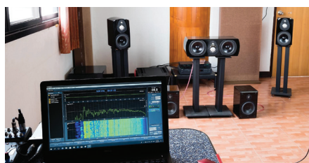
ขับไมค์ออกนอกแนว Off Axis ด้านข้างไปมาก ก็ยังไม่พบลักษณะของ Comb Filter แต่อย่างไร
