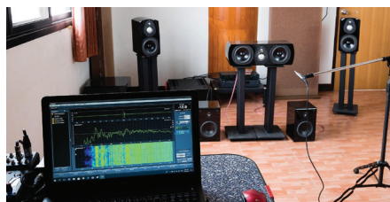
ลำโพงที่ออกแบบมาเพื่อใช้เป็นลำโพง Center เมื่อใช้ไมค์วัดตรงกลาง ไม่พบ Comb Filter
