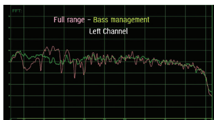
กราฟตอบสนองความถี่ของลำโพงหน้าซ้าย ที่เปรียบเทียบระหว่างการตั้งแบบ Full Range (สีชมพู) และ Bass Management (สีเขียว)
